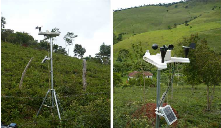
Figura 10 Estação meteorológica compacta completa Campbell® Fonte: Pereira (2009)
