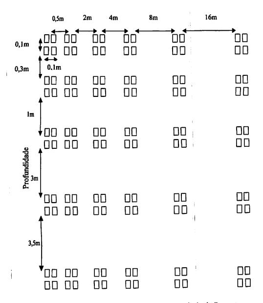
Figura 4.2. Esquema de coleta das amostras para o ensaio de cisalhamento.
