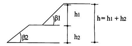
Figura 4.5 Construção de taludes em bermas.
