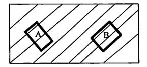
Figura 4.1. Amostra de solo com forte xistosidade de onde foram moldados corpos de prova: Paralelo (A) e transversal (B).
