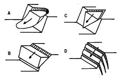
Figura 4.3. Principais tipos de ruptura em taludes. Ruptura circular (A), ruptura plana (B), ruptura em cunha (C) e ruptura em blocos (D).
