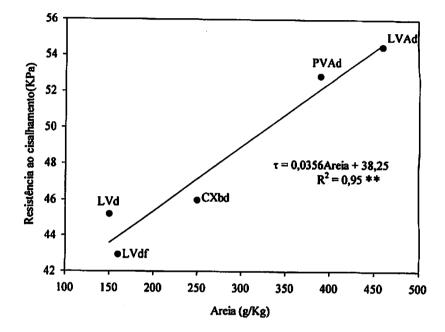
Figura 2.5. Relação entre resistência ao cisalhamento e a quantidade de areia dos Solos.
