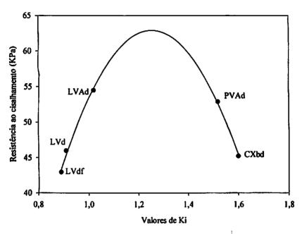
Figura 2.8. Relação entre resistência ao cisalhamento e o índice Ki dos solos.
