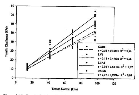
Figura 3.10. Envoltória de resistência ao cisalhamento dos horizontes A dos solos estudados.
