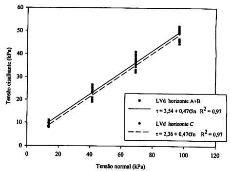
Figura 3.6. Envoltória de resistência dos horizontes A + B e C para o LVd
