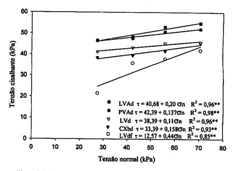
Figura 2.2. Envoltórias de resistência para os cinco solos estudados.
