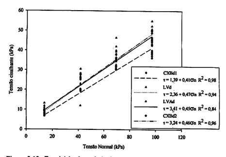
Figura 3.12. Envoltória de resistência ao cisalhamento dos horizontes C dos solos estudados.
