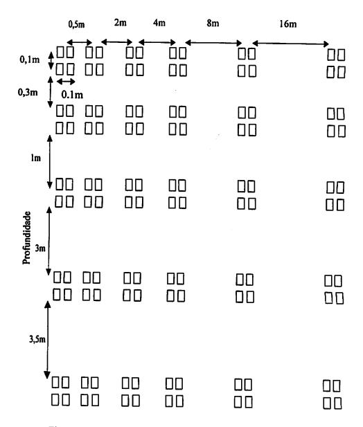
Figura 3.2. Esquema de amostragem para o ensaio de cisalhamento direto.
