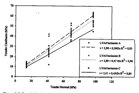
Figura 3.7. Envoltória de resistência dos horizontes A, B e C para o LVAd.
