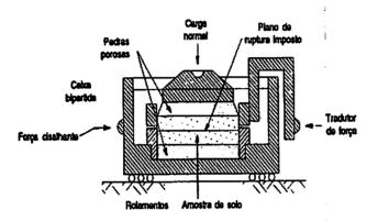
Figura 2.1. Diagrama esquemático da Caixa de cisalhamento utilizada em ensaios de cisalhamento direto.
