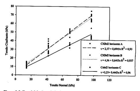
Figura 3.8. Envoltória de resistência dos horizontes A, B e C para o CXBd2
