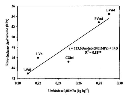
Figura 2.4. Relação entre resistência ao cisalhamento dos solos e umidade dos solos à tensão de 0,01MPa.
