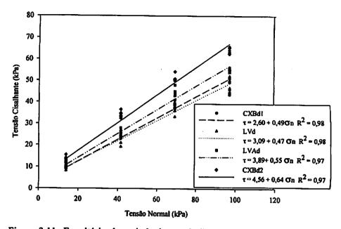
Figura 3.11. Envoltória de resistência ao cisalhamento dos horizontes B dos solos estudados
