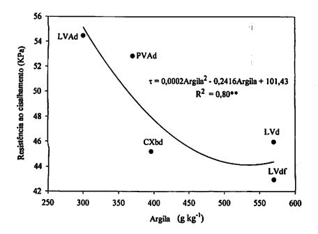
Figura 2.6. Relação entre resistência ao cisalhamento com a quantidade de argila dos solos.
