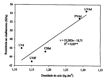
Figura 2.3. Variação da resistência ao cisalhamento dos solos em função da densidade do solo.
