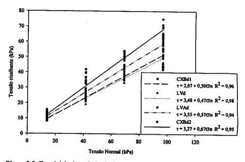
Figura 3.9. Envoltória de resistência dos horizontes A + B dos solos estudados.
