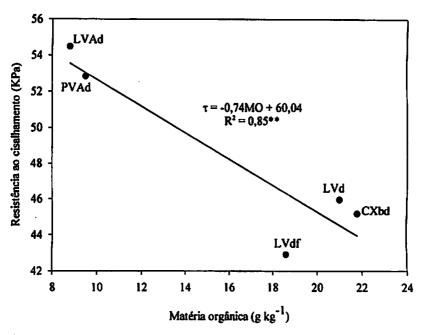
Figura 2.7. Relação entre resistência ao cisalhamento e o teor matéria orgânica do solos
