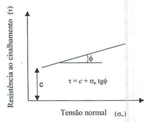
Figura 3.1. Envoltória de resistência, definida como a relação linear entre tensão normal e de cisalhamento.
