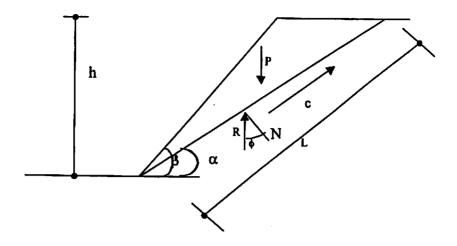
Figura 4.4. Diagrama de forças ativas e resistivas em um talude em terra instável.
