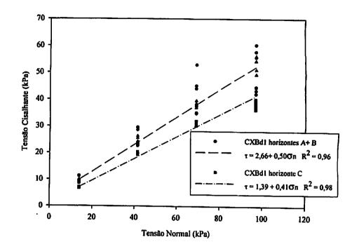
Figura 3.4. Envoltória de resistência dos horizontes A+ B e C para o CXBd1.
