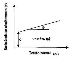
Figura 1.1. Envoltória de resistência definida como a relação linear entre tensão normal e de cisalhamento.
