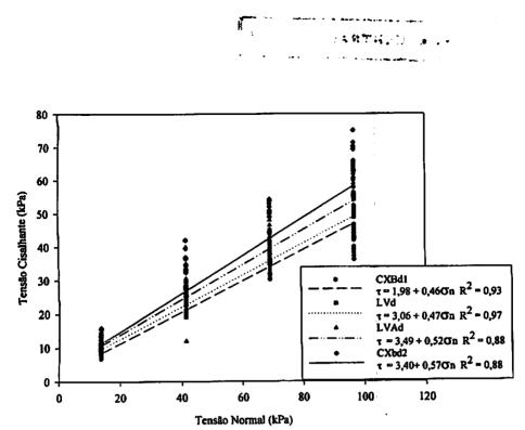
Figura 3.14. Envoltória de resistência ao cisalhamento dos quatro solos estudados.
