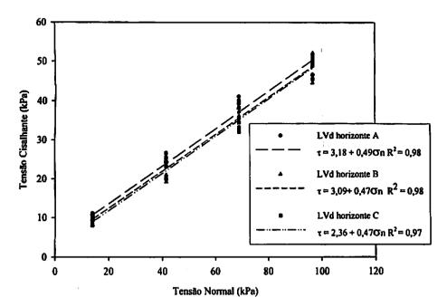
Figura 3.5. Envoltória de resistência dos horizontes A, B e C para o LVd TABELA 3.5. Comparação das envoltórias de resistência ao cisalhamento dos horizontes A, B e C para o LVd, utilizando o procedimento descrito em Snedecor & Cochran (1989).
