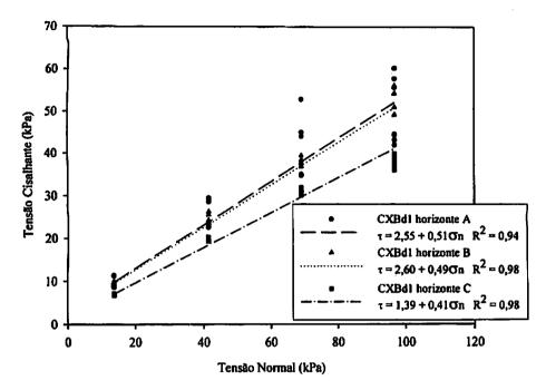
Figura 3.3. Envoltória de resistência dos horizontes A, B e C para o CXBd1.
