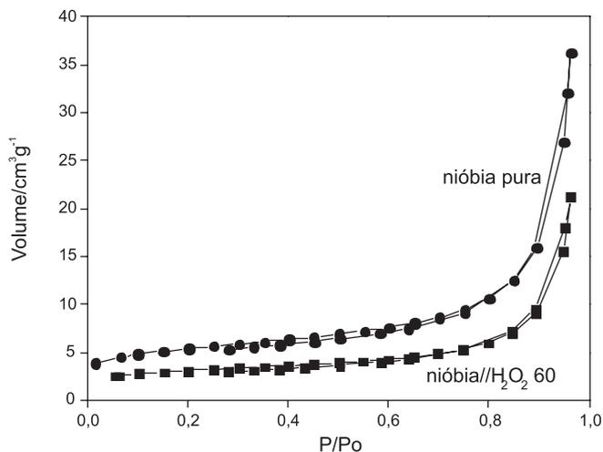
Figura 2S. Isotermas de adsorção/dessorção de N<sub>2</sub> para nióbia pura e nióbia//H<sub>2</sub>O<sub>2</sub> 60
