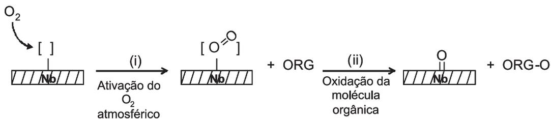
Figura 5S. Esquema simplificado do processo de ativação de O<sub>2</sub> e oxidação da molécula orgânica
