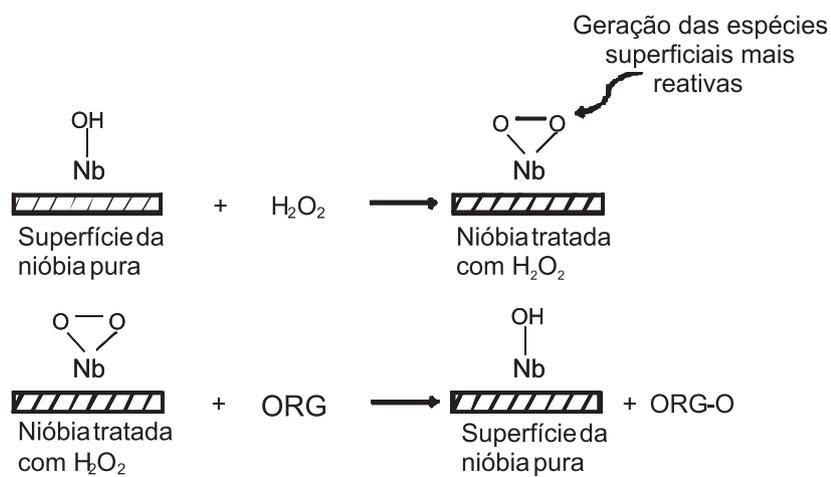
Figura 4S. Esquema simplificado da modificação superficial da nióbia após tratamento com H<sub>2</sub>O<sub>2</sub> e da oxidação do corante AM
