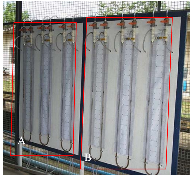
Figura 2. Manômetros diferenciais utilizados para determinação da perda de carga na tubulação (A) e da vazão (B) através das placas de orifício
