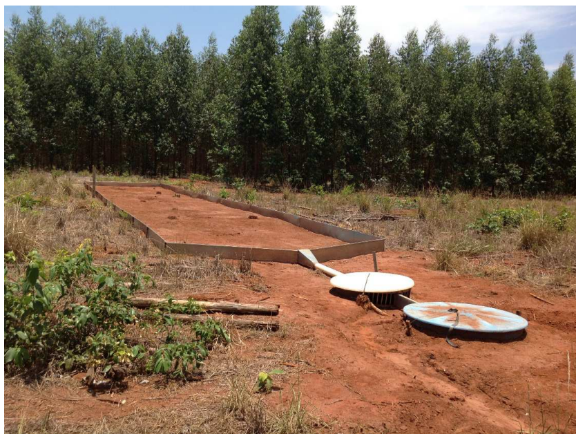
Figura 2. Parcela para coleta de perdas de solo e água nos sistemas com solo descoberto, vegetação nativa, eucalipto sem resíduo e eucalipto em desnível.
