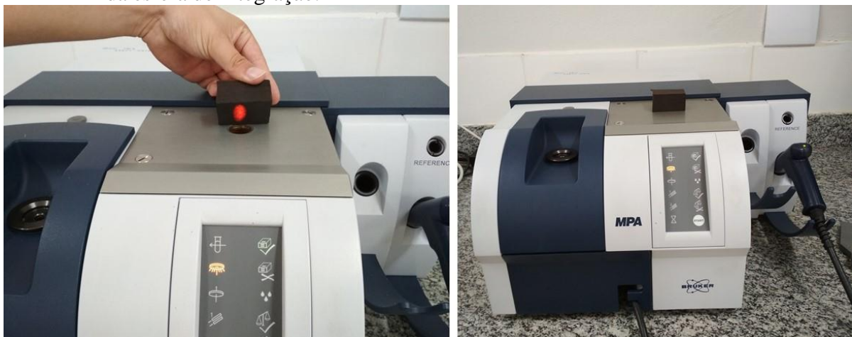
Figura 2 – Aquisição dos espectros no NIR diretamente na face radial dos carvões por meio da esfera de integração.
