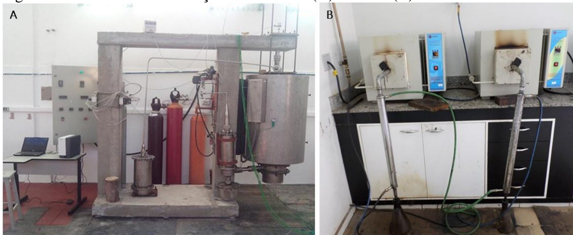
Figura 1 – Fornos de carbonização Macro ATG (A) e Mufla (B).
