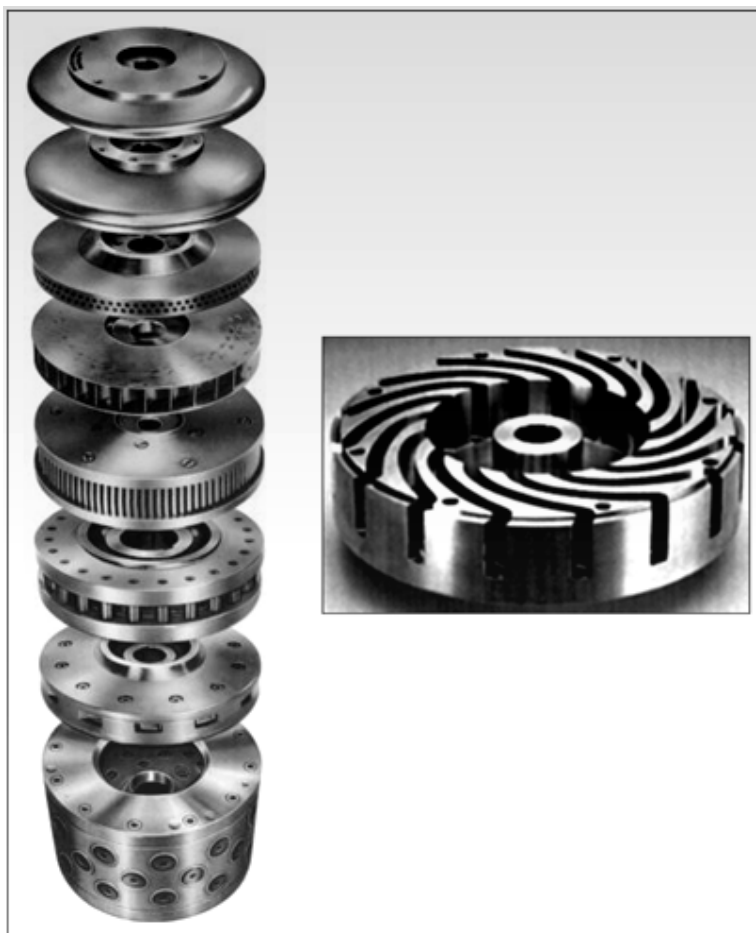
Figura 24 Discos centrífugos. A posição do orifício é a mesma para todos os quadros
