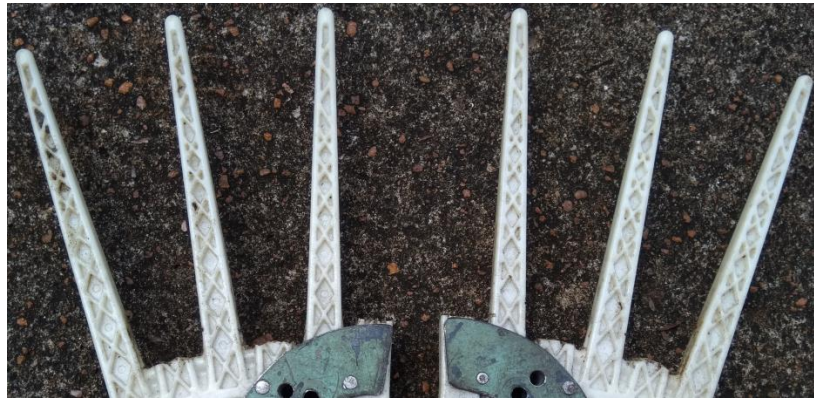
Figura 17 - Derrçadores modificados para os ensaios de derraça por vibraçaõ.
