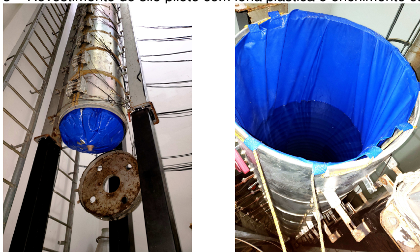
Figura 73 – Revestimento do silo piloto com lona plástica e enchimento com água.
