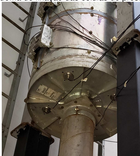
Figura 69 – Esquema de fixação das células de pressão na tremonha.
