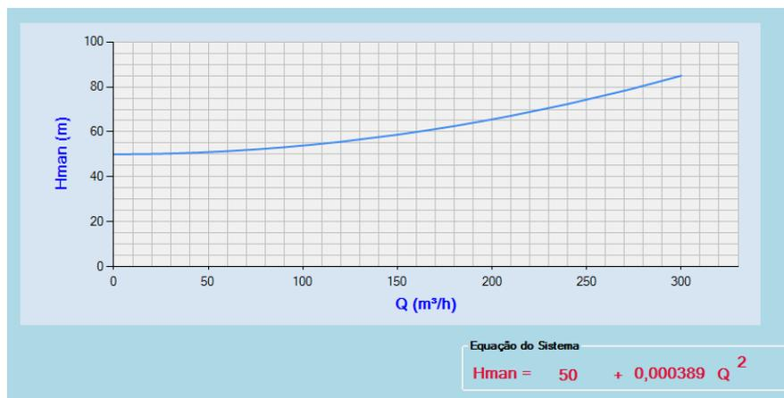
Figura 22 Curva do sistema com respectiva equação
