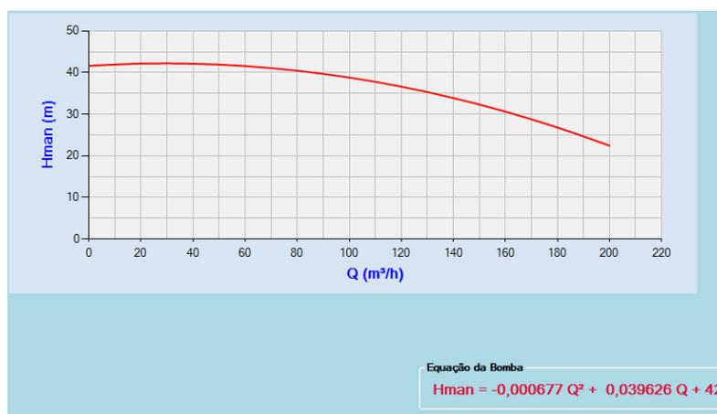
Figura 37 Curva e equação geradas pelo software
