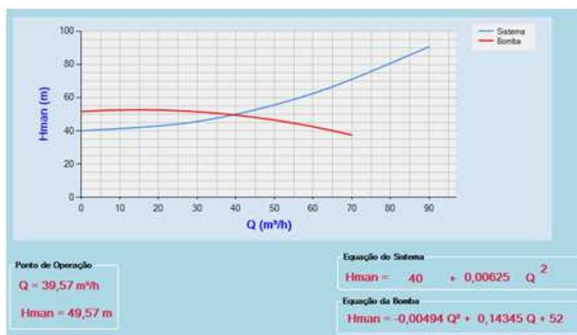
Figura 30 Curva da bomba e do sistema e ponto de operação calculado
