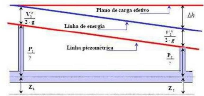
Figura 1 Esboço do balanço de energia em uma tubulação
