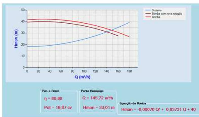
Figura 41 Tela de saída com a alteração da rotação da bomba
