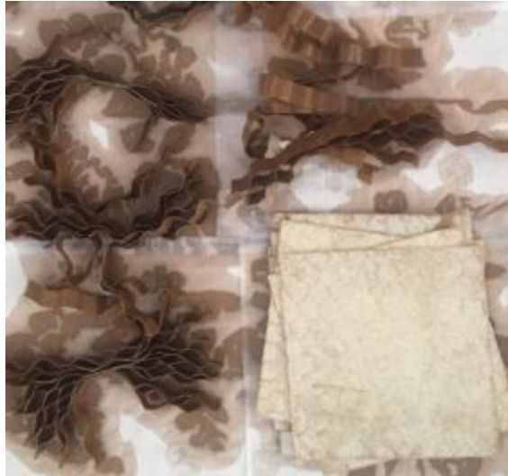
Figura 6 – Perda da estrutura dos painéis colmeia após imersão em água após período de 24h
