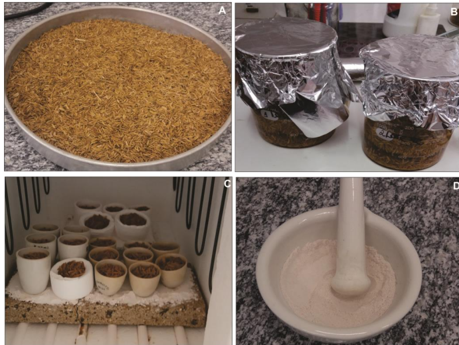
Figura 4 - Processo de tratamento das cascas de arroz para obtenção das cinzas.
