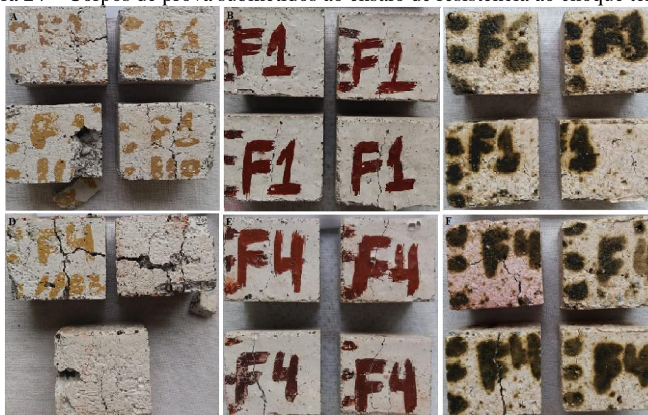
Figura 24 – Corpos de prova submetidos ao ensaio de resistência ao choque térmico.
