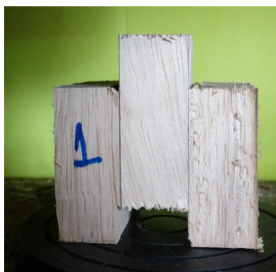
Figura 1. Corpo de prova estrutural utilizado no ensaio de cisalhamento na linha de cola dupla.
