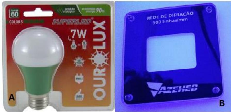
Figura 5 - Modelo das lâmpadas. A figura (A) mostra o modelo das lâmpadas que foram utilizadas nas caixas d'água, a figura (B) é uma rede de difração que foi utilizada para difratar as luzes usadas no experimento.
