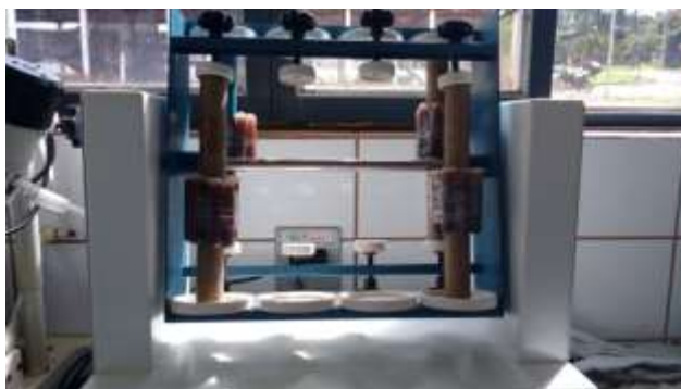
Figura 3. Suspensões em agitador vertical tipo Wagner por 24 horas
