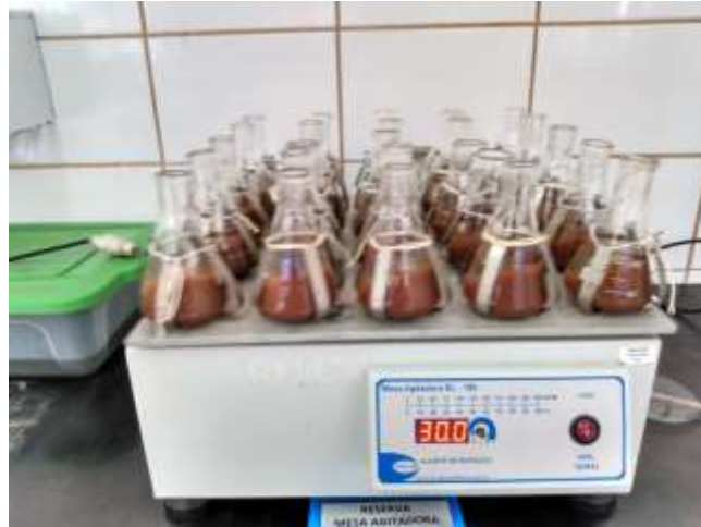
Figura 2. Erlenmeyers em mesa agitadora com intensidade moderada por 12 horas.
