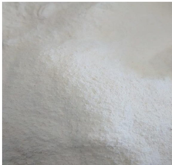
Figura 3 - Casca de ovo de galinha, seca, triturada e homogeneizada após passagem em peneira de 0,425 mm.
