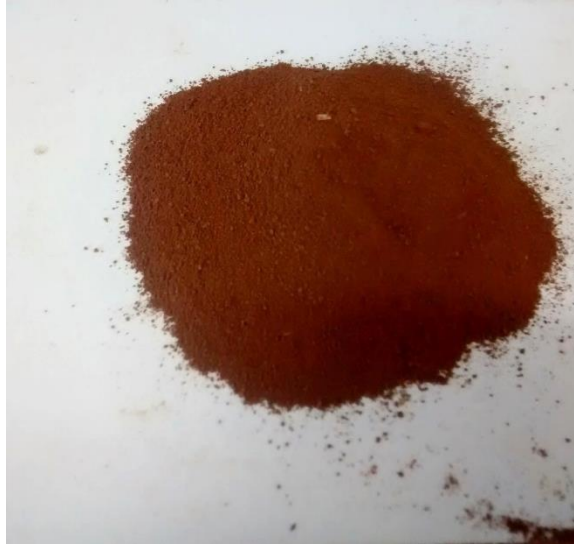
Figura 2 - Lodo da estação de tratamento de água, seco, triturado e homogeneizado após passagem em peneira de 0,425 mm.
