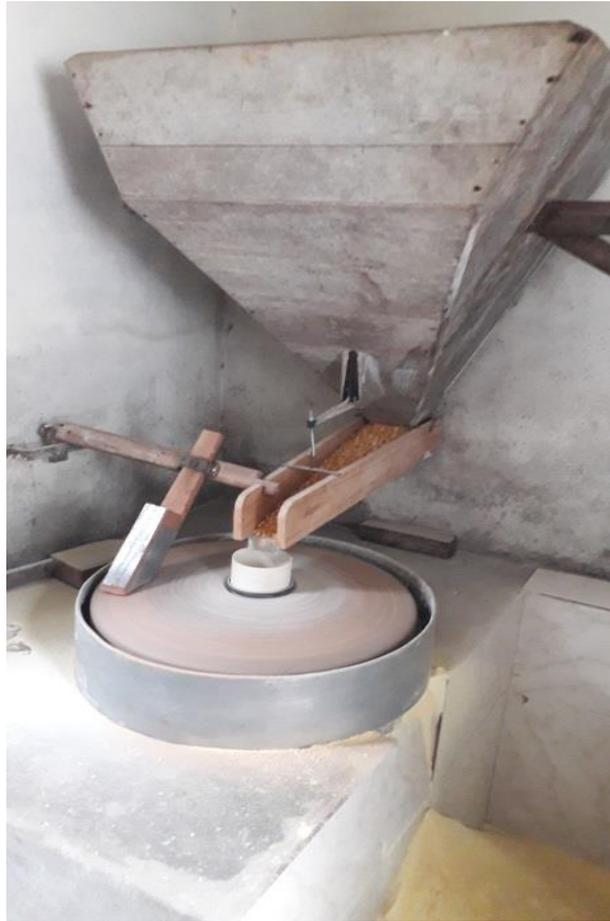
Legenda: Na foto tem-se o moinho de pedra utilizado por P5 para moer o milho, visando a obtenção do fubá utilizado na etapa de fermentação.
