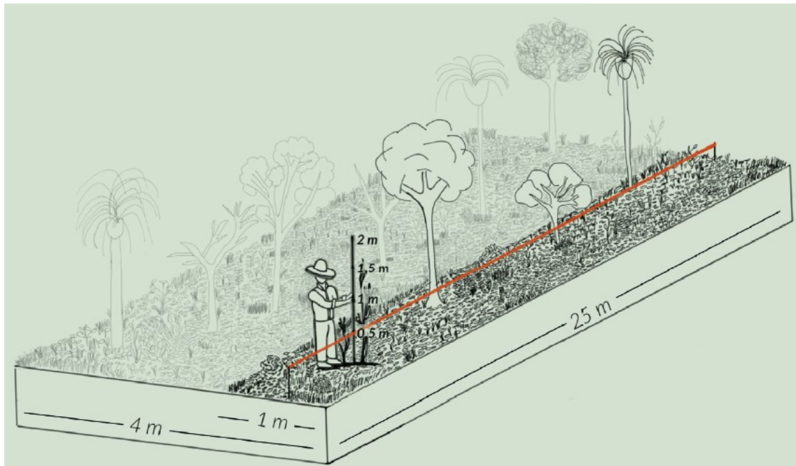
Figura 7 - Esquema representativo da amostragem de cobertura do solo pelo método de interceptação de pontos em classes de altura.
