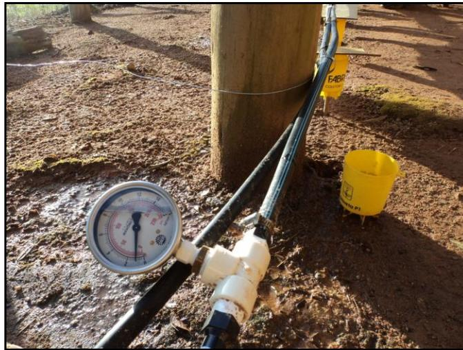
Figura 4.4 - Posição do manômetro na entrada do tubogotejador
