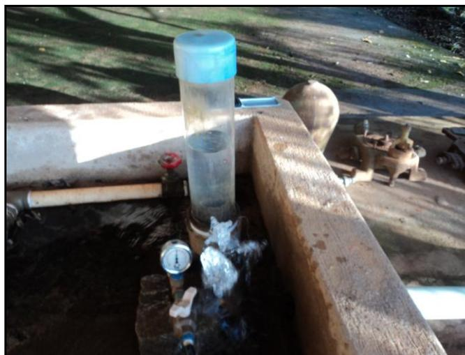
Figura 4.5 – Carneiro hidráulico de PVC comercial em funcionamento
