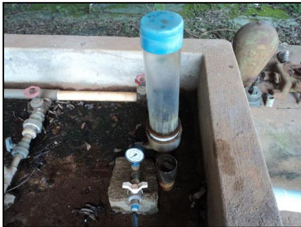
Figura 4.1 – Carneiro hidráulico de PVC comercial
