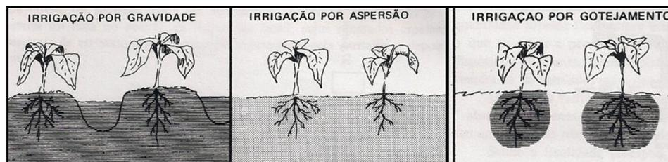
Figura 3.5 - Perfil do solo para diferentes técnicas de irrigação
