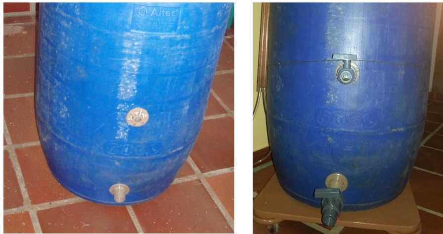
Figura 6 Flanges superior e inferior (foto da esquerda) e válvulas (foto da direita)
