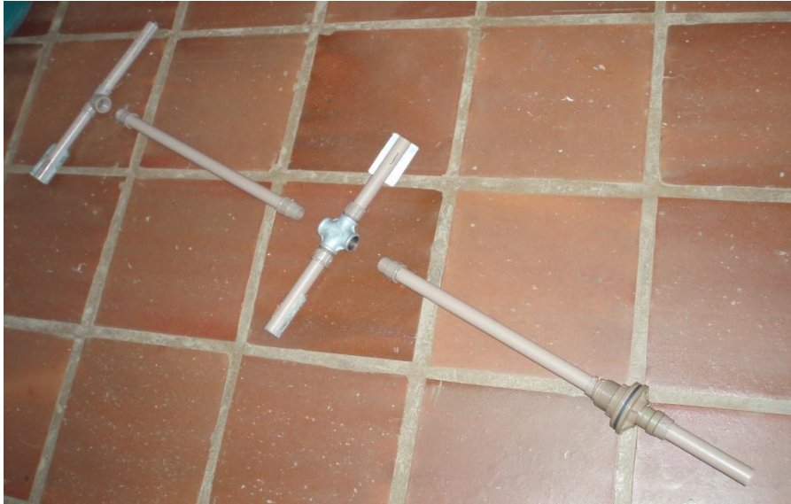
Figura 1 Braços agitadores montados. Eixo central alinhado em sua posição final.
