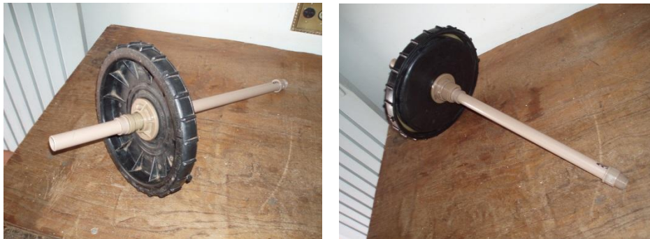
Figura 4 Vista da parte superior (foto da esquerda) e inferior (foto da direita) da tampa da bombona, com o flange de rotação já instalada.
