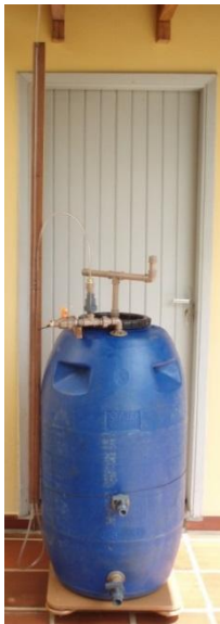
Figura 7 Biodigestor completo, montado sobre uma base com rodízios, para facilitar a movimentação.
