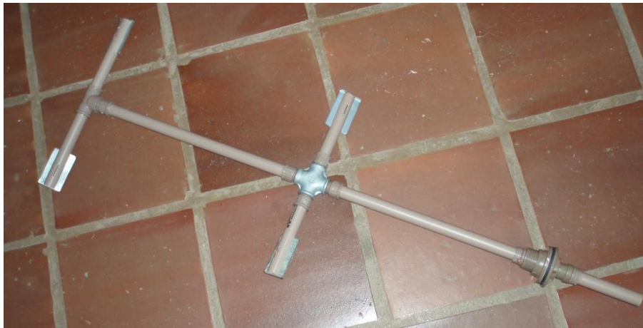
Figura 2 Parte interna do misturador montada. Note a angulação das palhetas de aço galvanizado.
