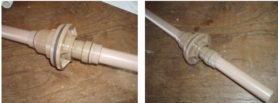
Figura 3 Detalhe do flange no tubo superior do misturador.
