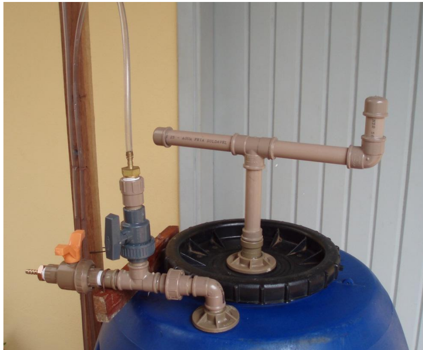
Figura 5 Manivela para rotação do misturador montada na ponta do eixo central.
