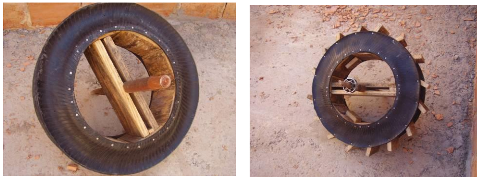
Figura 13 Processo de montagem da roda d'água
