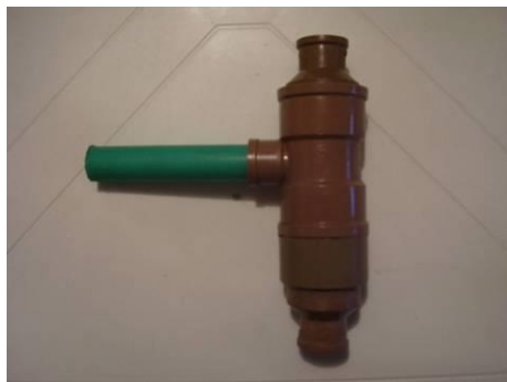
Figura 7 corpo da bomba com as válvulas de entrada e saída
