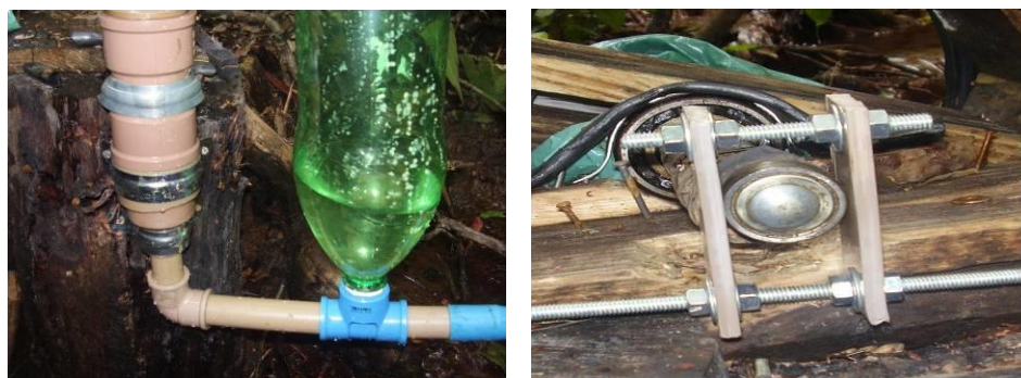
Figura 14. Detalhes da fixação da bomba e do eixo
