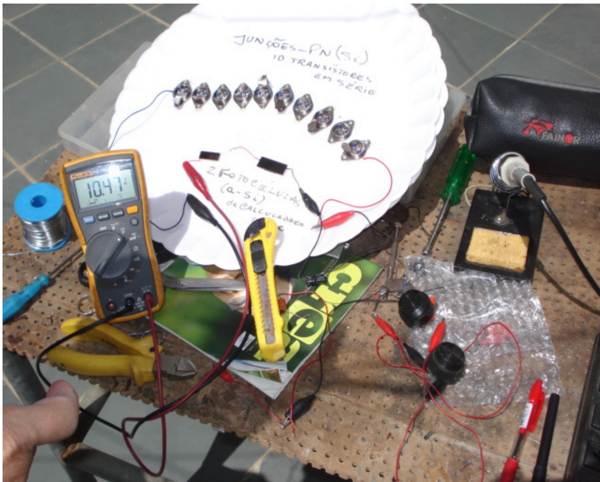
Figura 12 - Experiência serial com transistor e células solares (Fonte: Aluno)
