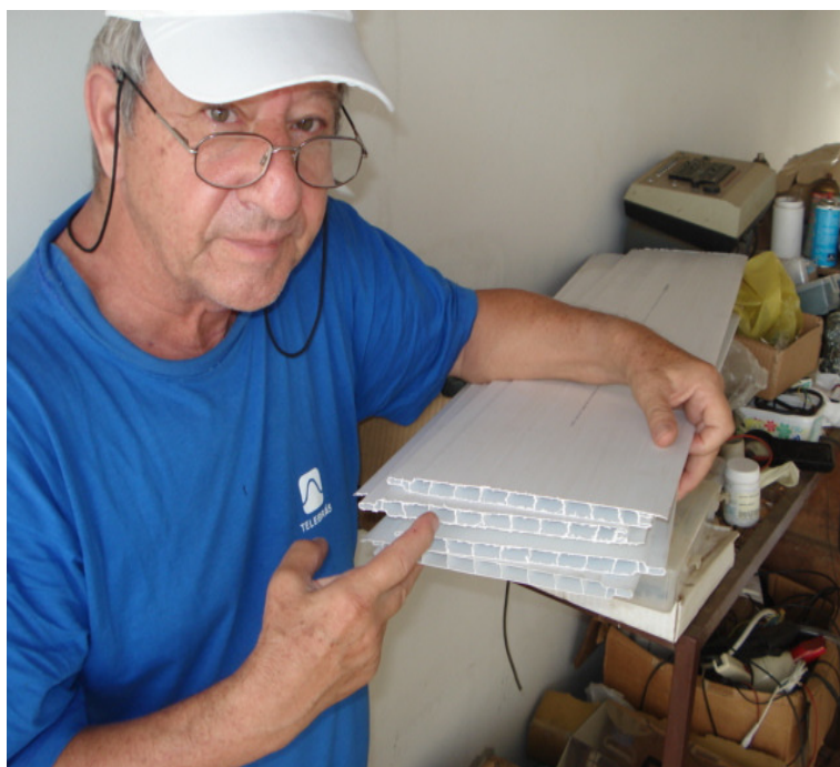
Figura 22 - Indicação do Forro PVC para Painel de Aquecimento (Fonte: Aluno)
