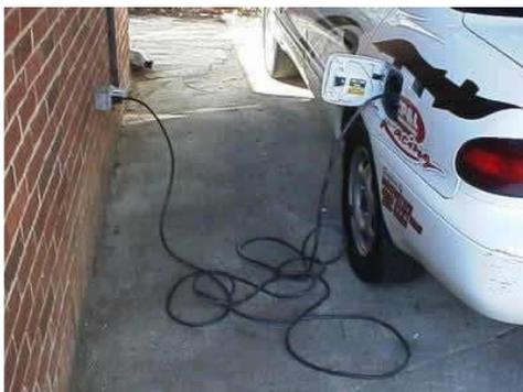
**FIGURA 34** - Conexão do plug de energia (macho) em um plug fêmea.
