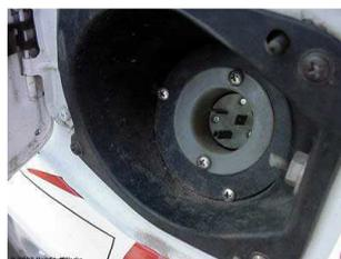
**FIGURA 33** - Plug de energia (macho) de um veículo elétrico
