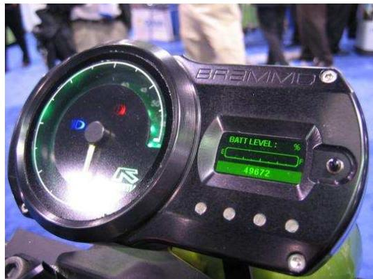
**FIGURA 14** - Painel de uma moto elétrica
