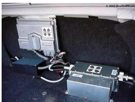
**FIGURA 36** - Sistema de recarga no porta malas, cortesia de Jon Mauney
