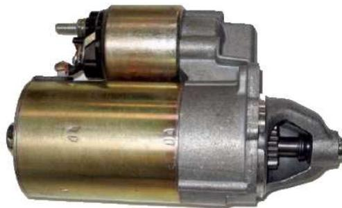
**FIGURA 7** - Motor de Arranque
