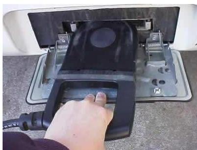
**FIGURA 37** - Conexão de placa indutiva no sistema de recarga acoplado atrás da placa do veículo, cortesia de Jon Mauney
