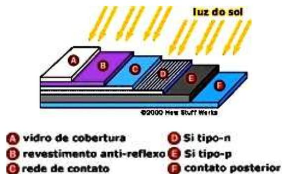
**FIGURA 21-** Estrutura básica de uma célula FV de silício genérica
