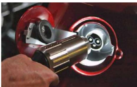
**FIGURA 38** - Sistema de Carregamento do Tesla Roadster 100
