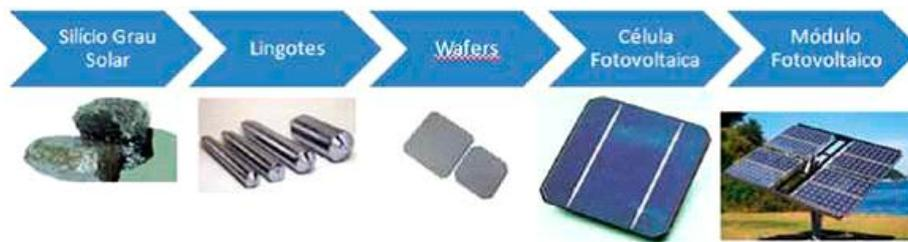
Figura 9 Etapas de produção do módulo fotovoltaico a partir do silício cristalino
