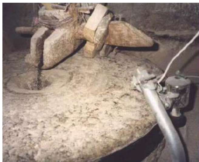
Figura 37- Dínamo “de bicicleta” acoplado à pedra de moinho do Gharat de madeira
