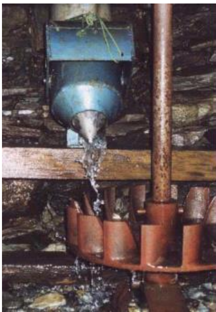
Figura 38- Gharat modernizado com injetor e rotor metálico
