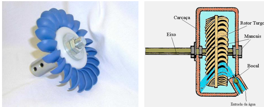
Figura 43- Exemplo de micro-turbina Turgo.
