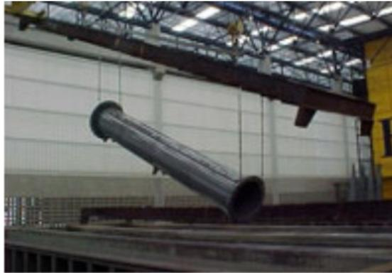
Figura 6 Processo de decapagem
