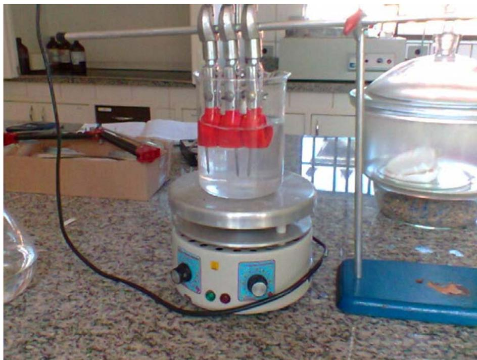
Figura 30 Teste de corrosão com pregos sem galvanização (controle), galvanizado a partir da solução recuperada (GR) e galvanizado a partir da solução sintética (GS)
