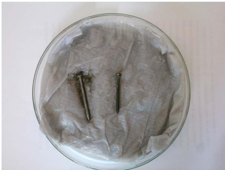
Figura 40 Teste de corrosão qualitativo com prego não galvanizado (a esquerda) e com prego galvanizado a partir da solução recuperada (a direita)
