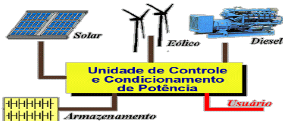
FIGURA 3.7: Esquema de um sistema solar híbrido. Fonte: CRESESB – Centro de Referência para Energia Solar e Eólica Sérgio de Salvo Brito, Rio de Janeiro – RJ.
