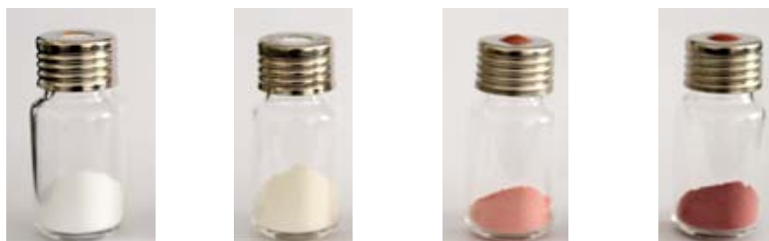
(A) (B) (C) (D) Figura 5 Catalisadores produzidos com diferentes quantidades de ferro. (A) ZrO_2 ; (B) Zr/Fe-1%; (C) Zr/Fe-2,5%; (D) Zr/Fe-5%
