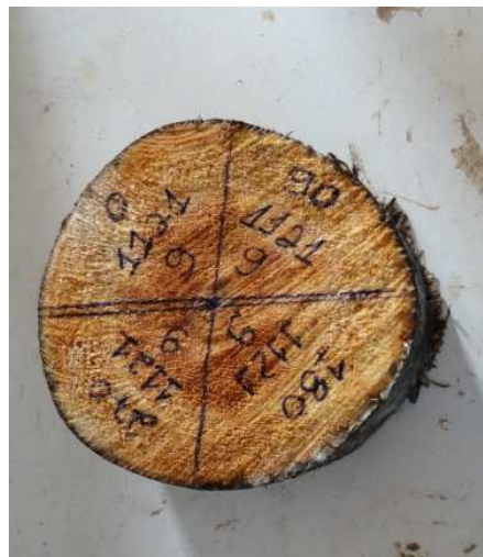
Figura 4 Preparo do disco para avaliações da densidade básica da madeira por clone e posições angulares de amostragem na circunferência à altura do peito (0, 90, 180 e 270°)
