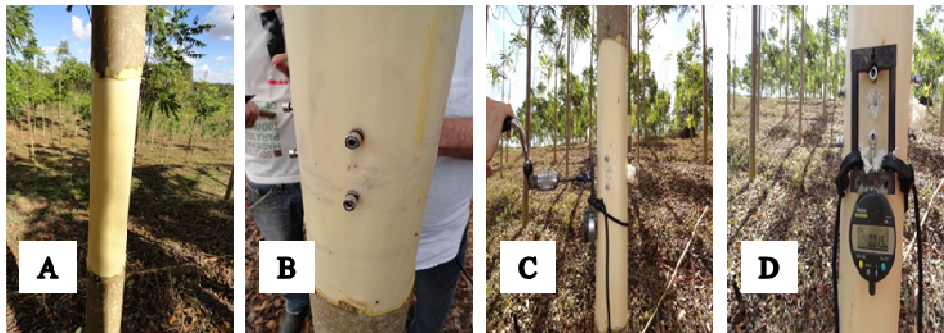
Figura 3 Sequência da medição da DRL na altura do peito, com a casca retirada (A), fixação dos pinos (B); perfuração entre os pinos com arco de pua (C); e do extensômetro com perfuração central com o arco de pua (D)
