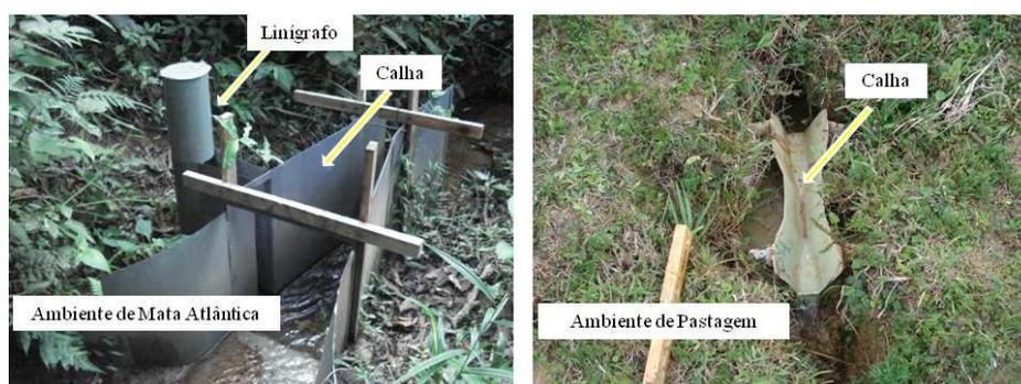
Figura 5 Equipamentos utilizados para aquisição de dados de vazão em ambos os ambientes monitorados
