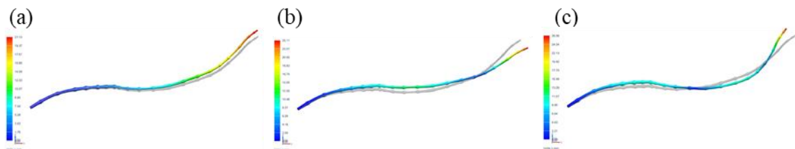
Figura 5.5 – Exemplo de resultado obtido nas simulações: (a) primeira frequência natural (b) segunda frequência natural e (c) terceira frequência natural.
