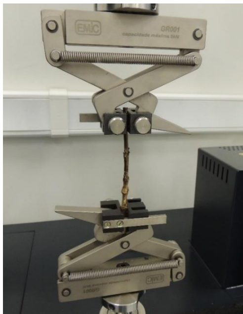
Figura 3.3 – Configuração experimental, corpo de prova fixado em duas garras para ensaio de tração.
