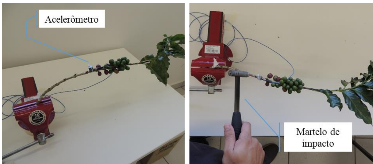
Figura 4.2 – Configuração de coleta de dados. Instalação do acelerômetro no centro do comprimento do ramo (esquerda) e simulação com martelo de impacto (direita).
