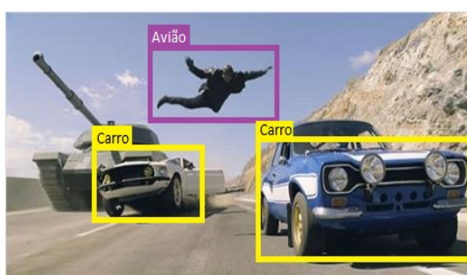
Figure 3.5 – Falha na detecção de objetos utilizando YOLO
