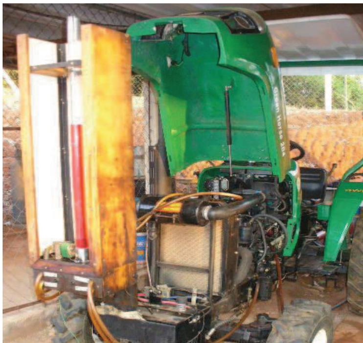
Figura 11 Medidor Volumétrico de Combustível.
