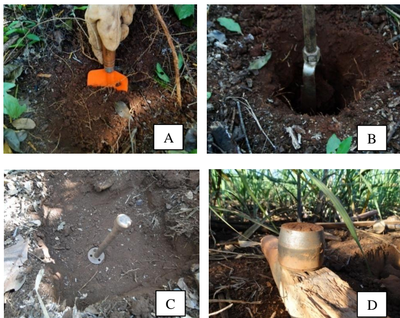
Figura 4 Coleta de material no campo: A) Retirada da camada 0-5 cm utilizando uma pá; B) Retirada de solo com trado holandês; C) Abertura da trincheira e coleta de amostras indeformadas de solo; D) Coletor de Kopeck
