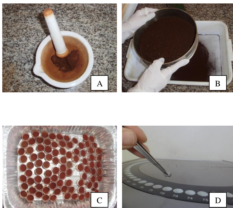
Figura 5 Preparo das amostras em laboratório: A) Solo sendo macerado em almofariz e pistilo; B) Solo sendo peneirado em peneira de 2 mm de diâmetro; C) Material acondicionado em potes plásticos para posterior análise; D) Amostra em cápsula de estanho sendo injetado ao analisador de carbono
