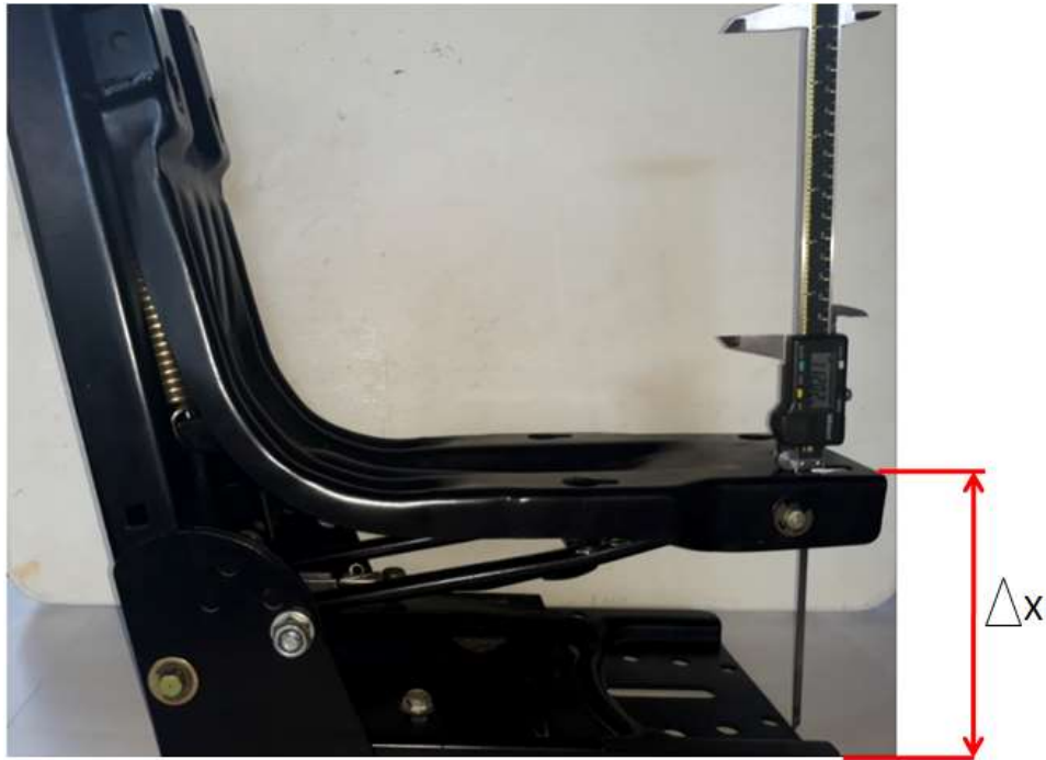
Figura 9: Referência de medição do deslocamento do suporte.
