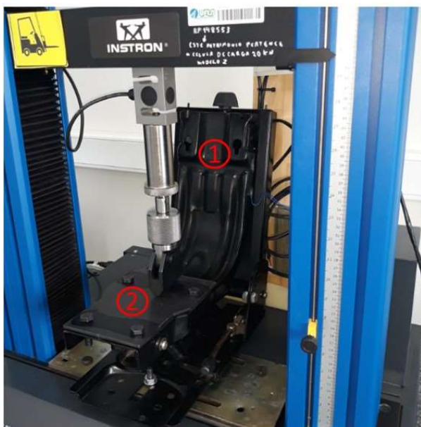
Figura 15: Setup experimento validação tensões.
