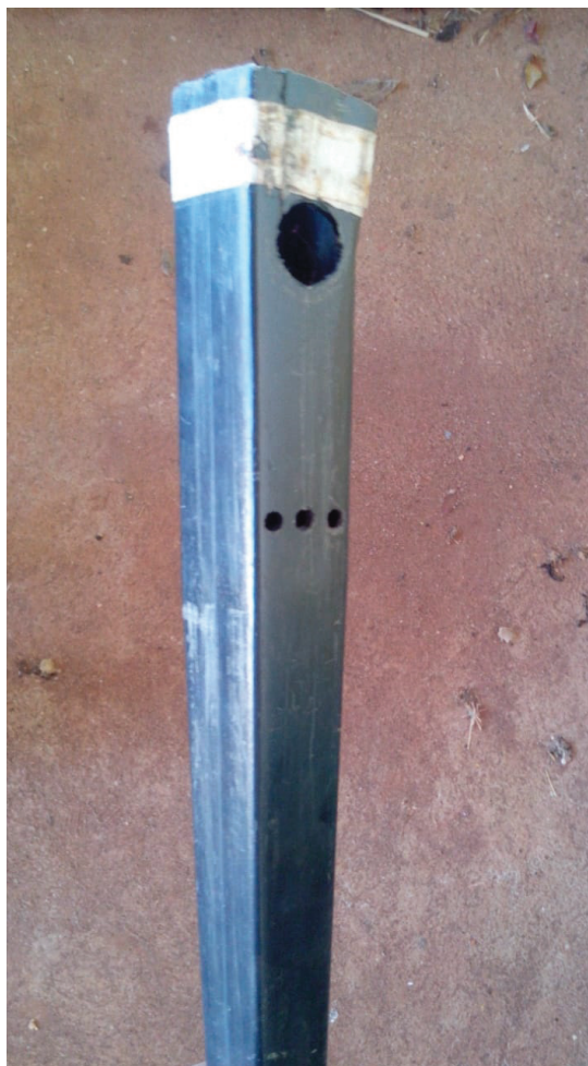
Figura 3.10 – Duto de aplicação dos insumos
