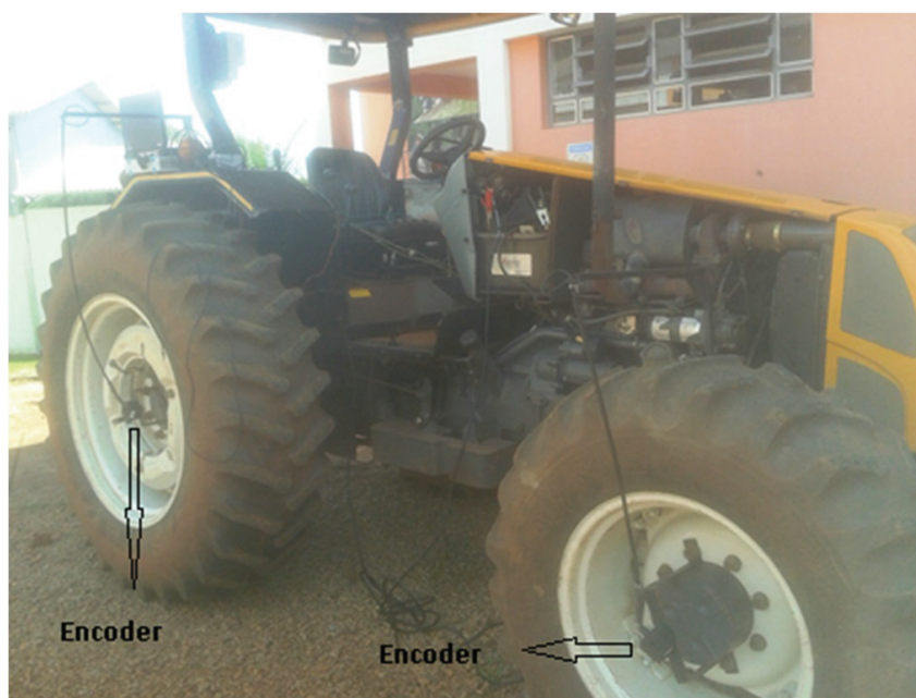
Figura 3.4 – Instalação dos encoders no trator
