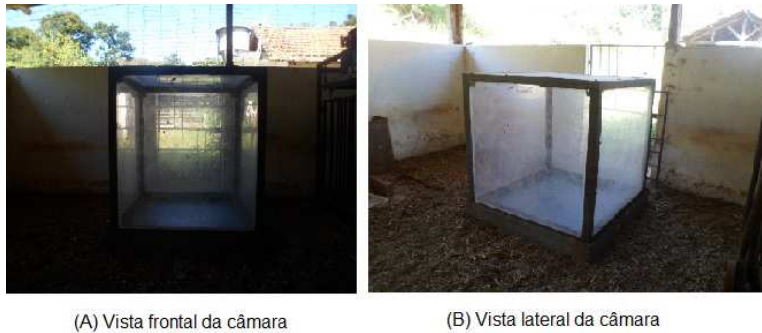
Figura 1 Caixa de policarbonato construída para aferir o consumo de O 2 de cordeiros em crescimento.
