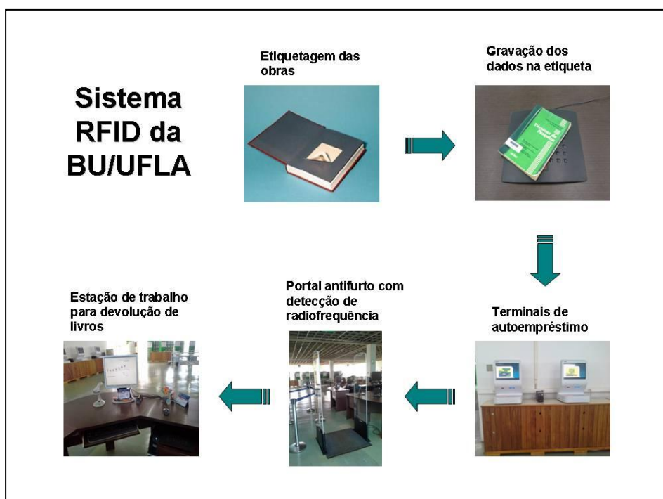
Figura 1 - Fluxograma do sistema RFID da BU/UFLA
