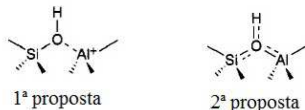
Figura 5 Propostas para a interação entre os átomos de oxigênio, hidrogênio, silício e alumínio presentes na estrutura de um aluminossilicato.
