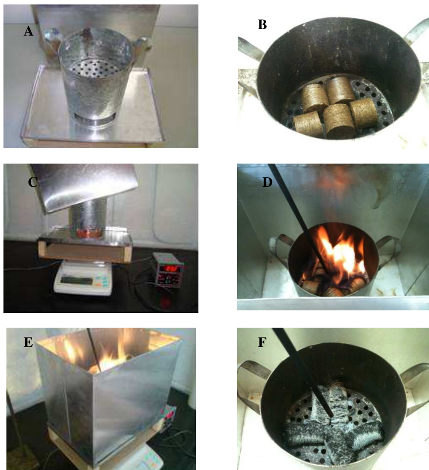
Figura 3 Funcionamento do equipamento combustor, (A) combustor; (B) combustor com briquetes; (C) anteparo protetor sendo colocado; (D) início da ignição e posição do sensor medidor de temperatura; (E) combustão; (F) material residual, final da combustão.
