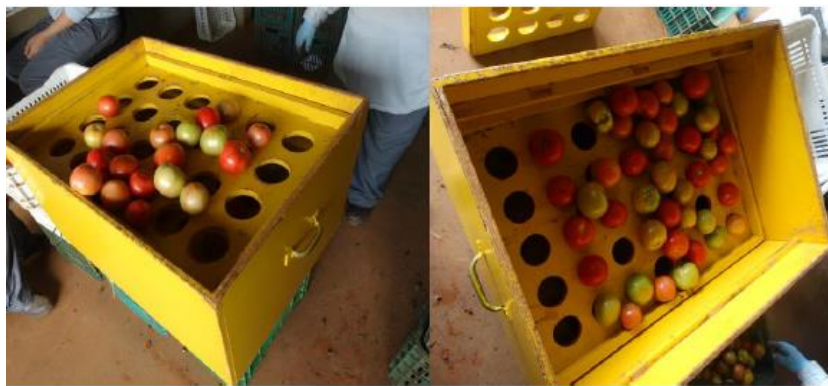
Figura 2 – Caixa de madeira utilizada para classificação com as respectivas peneiras de 85 milímetros (peneira superior) e 65 milímetros (peneira inferior).
