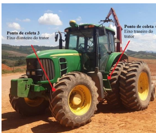
Figura 3.2: Pontos de coleta de dados externos no trator.
