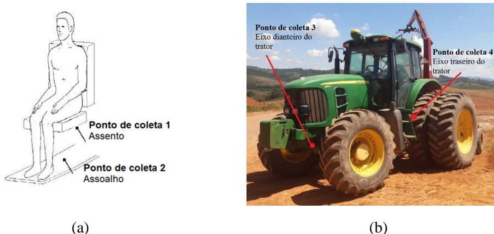
Figura 4.1: Pontos de coleta de dados na cabine de operação (a) e externos à cabine (b).
