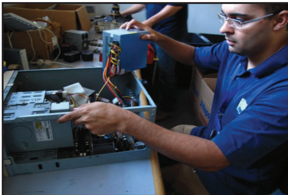
Figura 3 - Equipe do CEDIR realizando a desmontagem dos equipamentos.
