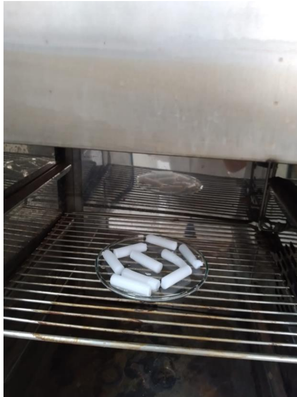
Figura 7 – Criogéis sendo secos em estufas
