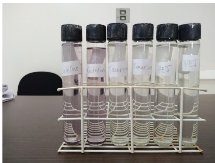
Figura 8 – Criogéis sendo funcionalizado com os ligantes
