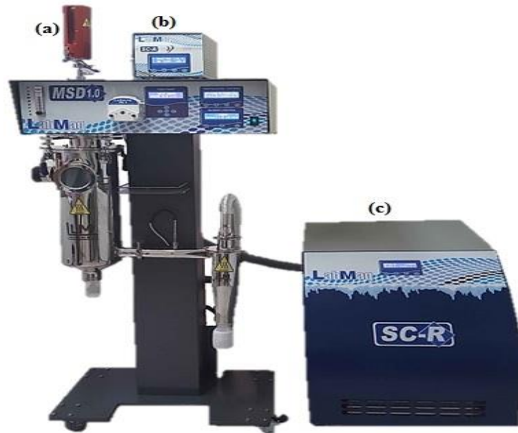
Figura 3 - Spray chiller. (a) Sistema de aquecimento da amostra. (b) Sistema de aquecimento do ar comprimido. (c) Sistema de resfriamento do ar (-5°C a 20°C).
