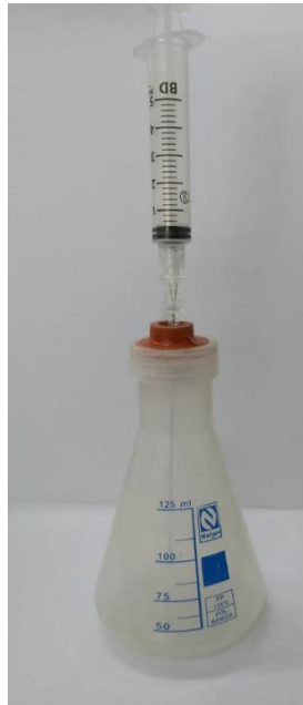
Figura 1 – Sistema utilizado na extração, ilustrando sistema de seringa usado para a retirada da amostra da fase extrato.
