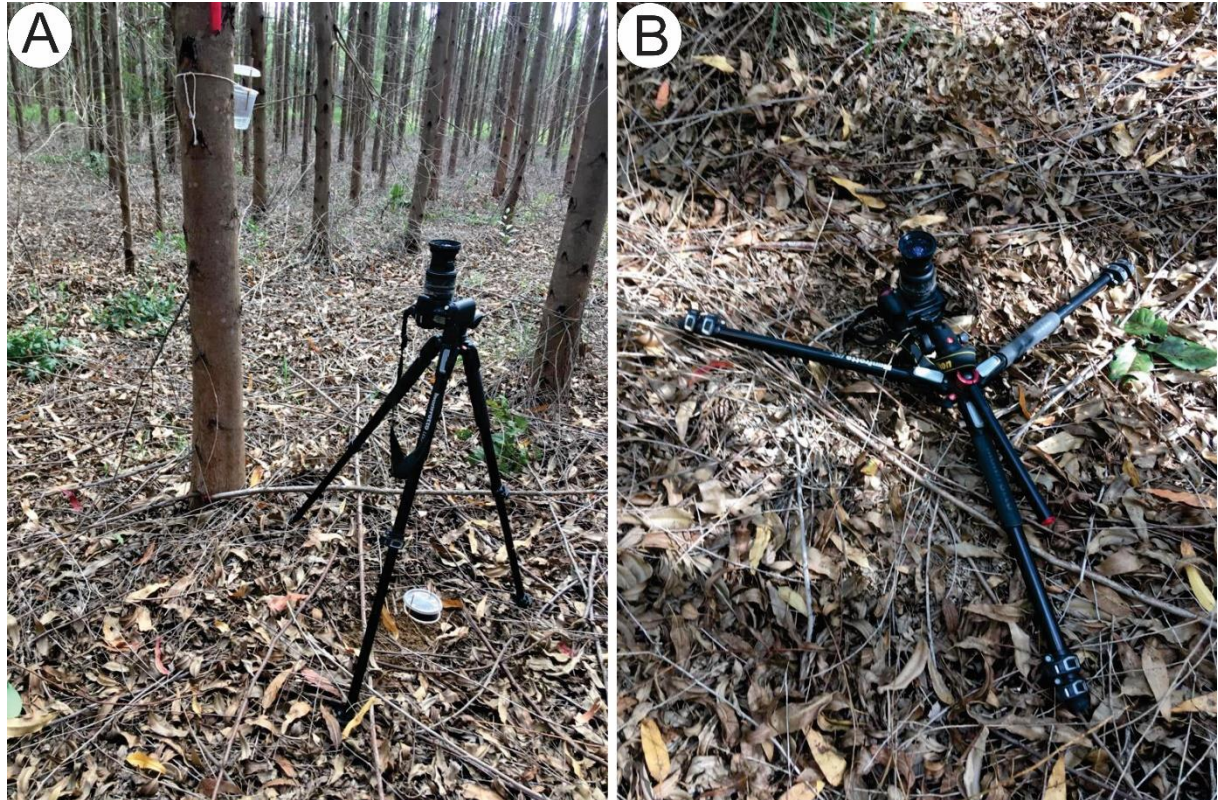
Figura 3 – Equipamento utilizado na realização das fotografias de dossel a) a um metro do solo; b) a 15 centímetros do solo.
