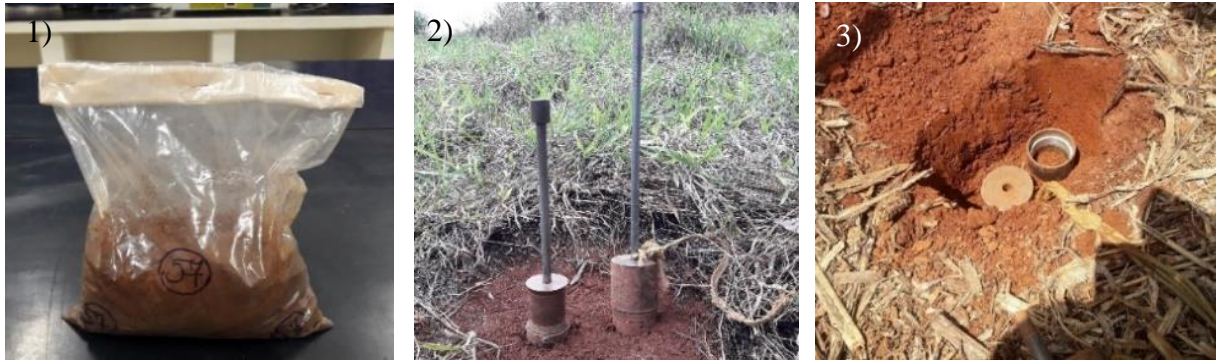
Figura 5 - Coleta de solo com estrutura deformada (1) e indeformada (2 e 3).
