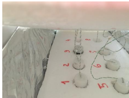
Figura 8- Armazenamento em caixa térmica em ambiente com controle de temperatura.
