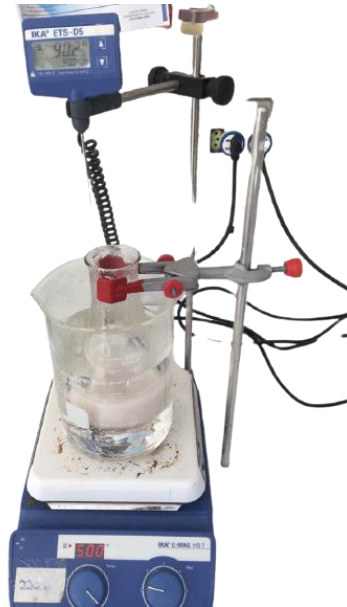
Figura 11- Agitação do CaO, cinza da casca do café e água isenta de CO 2 , em temperatura constante.
