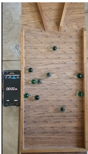
Figura 6.8 – Detalhe da tábua de pregos para a prática experimental representando o Modelo de Drude
